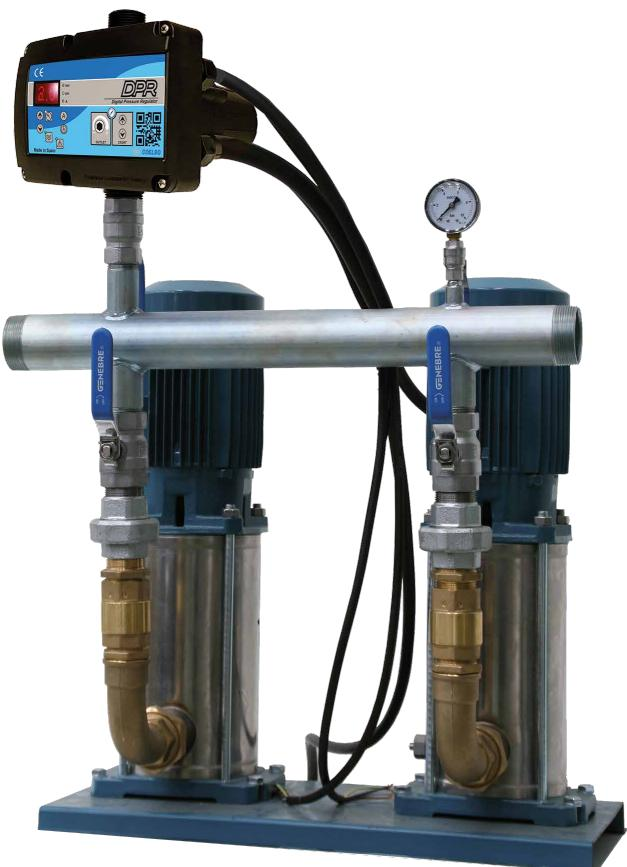
Un dispositivo **DPR alt** permite controlar grupos de dos bombas monofásicas constituyendo un grupo de presión con funcionamiento alternado -nunca funcionarán simultáneamente - y presión constante de salida. Este sistema garantiza el suministro de agua en caso de avería de una de las dos bombas y aumenta su vida útil.
