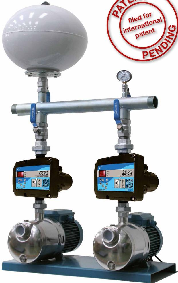
Dos unidades **DPR master** pueden ser comunicadas para controlar grupos de dos bombas monofásicas, constituyendo un grupo de presión con orden de puesta en marcha alternado y funcionamiento en cascada, a presión constante.
